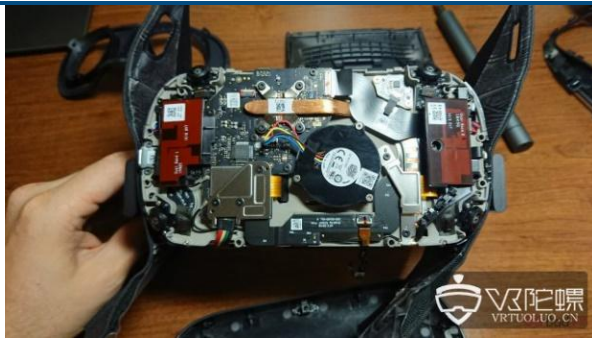
图表23: Oculus Quest 拆解图
